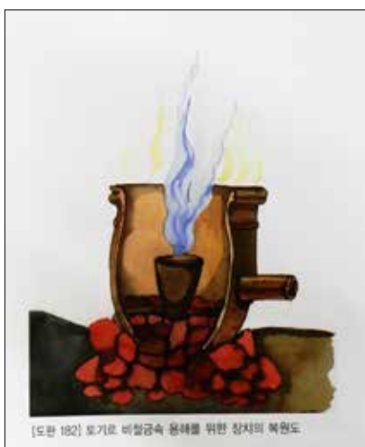
図71. 韓国で考えられている坩堝法か？この図は使い方が間違えている。中に装填されている坩堝が密閉されていない。
