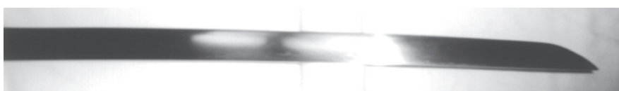
図 17-18. 刀身はダマスカス刀の如く数回の折り返し鍛錬で作られた可能性があり、強靱性は低い。蕨手刀には、これに類似する地鉄がまま見られる。鋒部分に片切刃の形跡が僅かに残っている。
