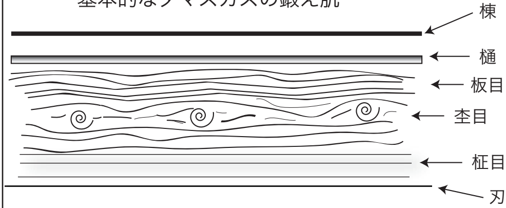
図 17-11. (上) 刀匠が説明してくれた基本的なダマスカス刀紋様。刀身部分には板目とそこに杓目を出す。刃部は柁目にする。月山に似ている。日本の大和伝について説明すると、「作り方は全く同じ」であると話してくれた。樋を付ける場合もある。これから考えると、彼らは五家伝の技術を持っている事になる。 (注) イラスト中の杓目は、筆者が説明のために判りやすく描いた物である。
